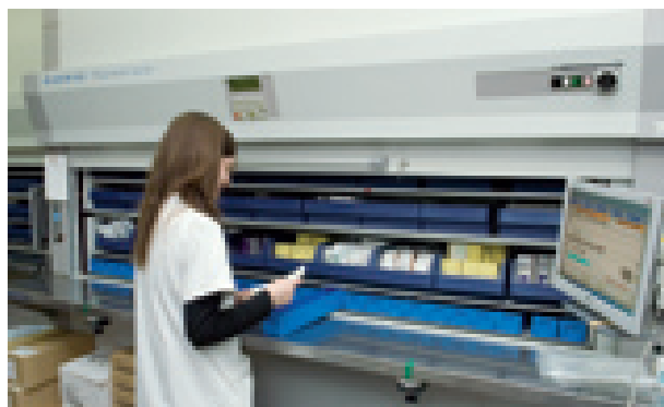
Servicio de Farmacia hospitalario. Sistema automatizado de dispensación de medicamentos.
