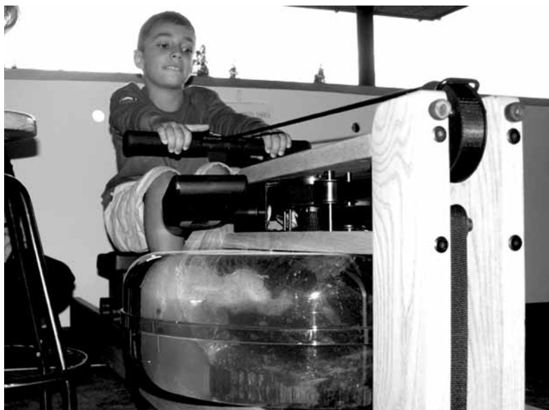
FIGURA 4.9: Experimento con máquina de remo para comprobar la relación entre el trabajo y el calor
