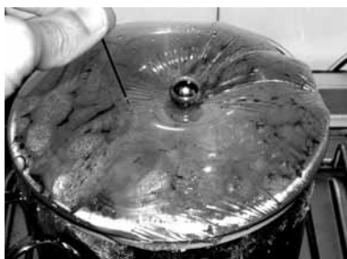
FIGURA 7.2a: Desalinizadora con fuente de calor (acumulación de vapor)
