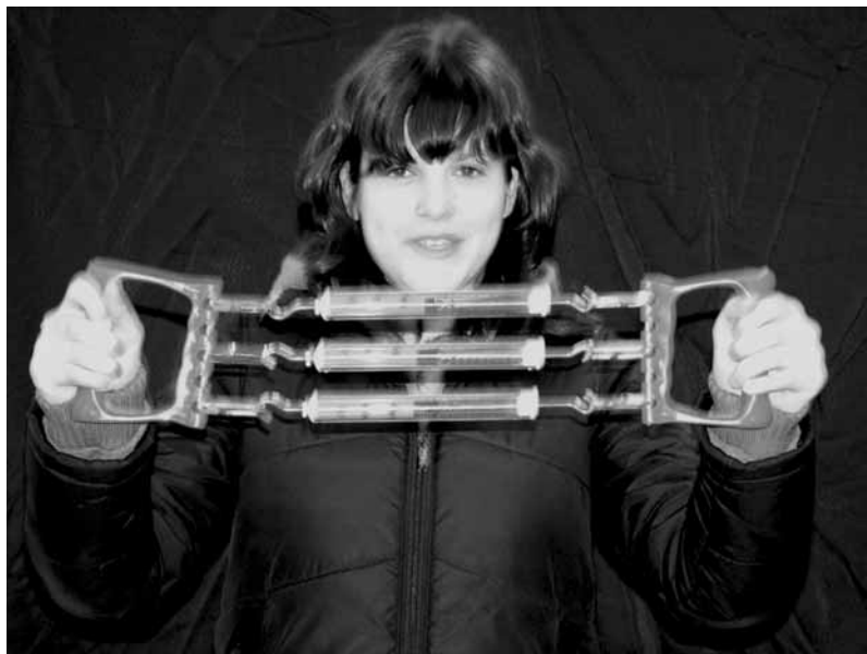
FIGURA 4.8: Instrumento de fuerza construido con dinamómetros didácticos
