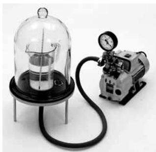
FIGURA 7.4: Desalinizadora con campana de vacío
