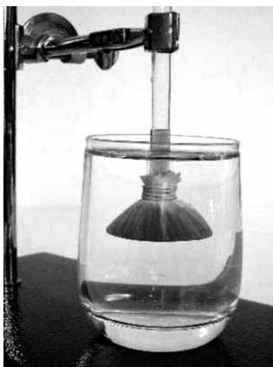
FIGURA 7.8: Experimento de ósmosis (con celofán)
