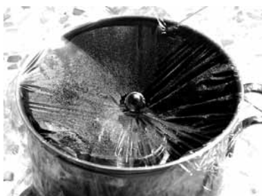
FIGURA 7.1b: Desalinizadora solar (arreglo experimental)
