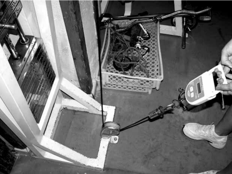
FIGURA 4.19: Toma de medida de fuerzas mediante dinamómetro digital
